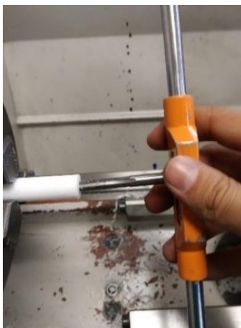
Figura 6 Roscado en barra de teflón
