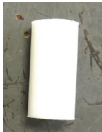
Figura 8 Prototipo Aislante de Teflón finalizado
