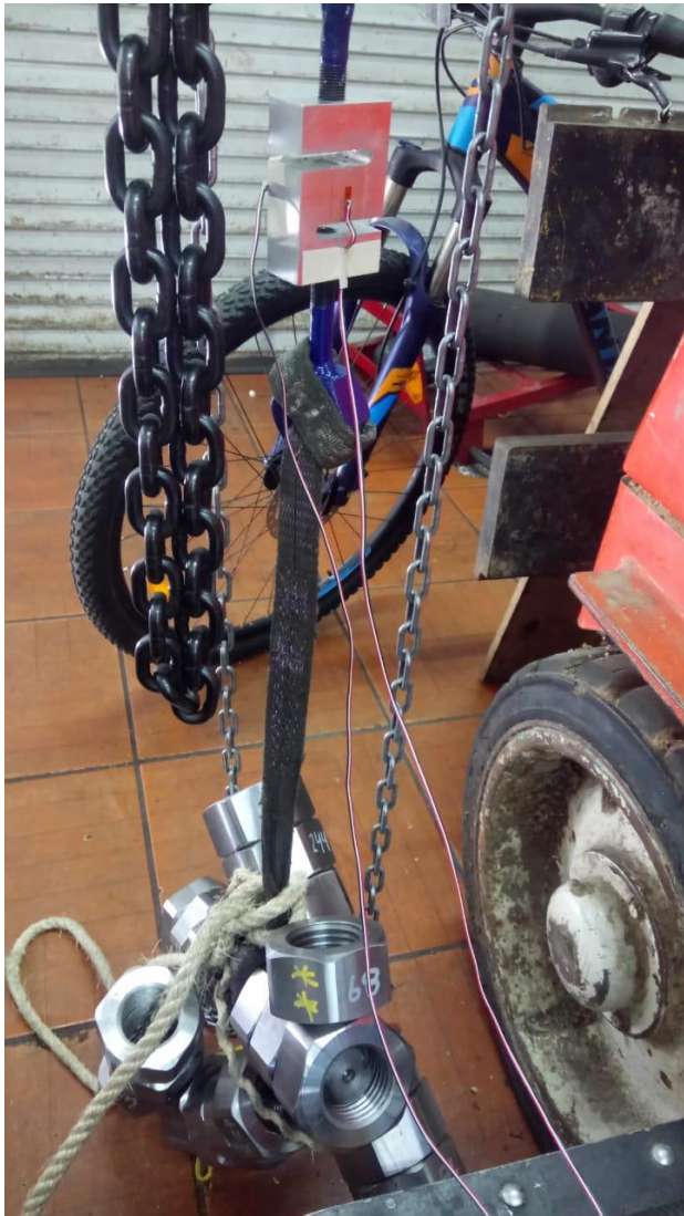
Figura 22 Arreglo de pesos añadido a la celda de carga para realizar la medición
