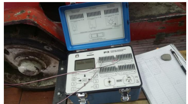
Figura 21 Equipo de medición P3 conectado a las galgas extensiométricas
