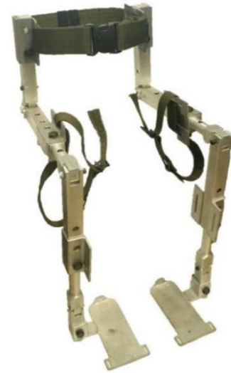
Figura 8 Prototipo físico de exoesqueleto de extremidades inferiores Fuente: Elaboración Propia (2019)
